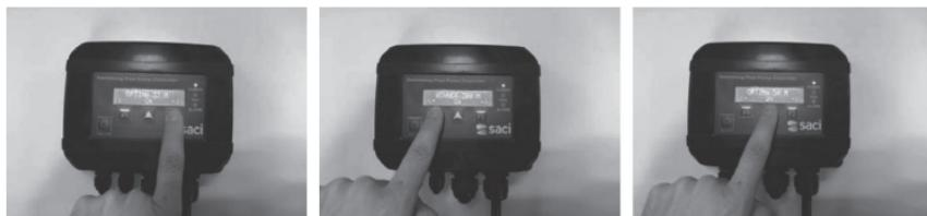
3. Volveremos a visualizar el idioma. Podemos desconectar el controlador de la corriente eléctrica. We will return to the language screen. We can disconnect the controller from the power supply.
