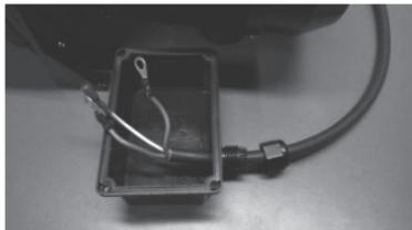
5. Introduzca los cables de conexión (no suministrados) según se observa en la figura. Enter the connection cables (not provided) as you can see on picture.
