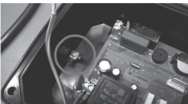
8. Atornille los conectores faston macho suministrados según se observa en la figura. Fix the male faston connectors provided with a screw.
