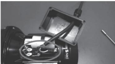
6. Atornille los cables de potencia a los pernos y conecte el cable de tierra al motor.
