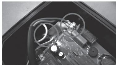
12. Conecte los cable de potencia a la borna "PUMP" y el cable de tierra al faston macho restante.
