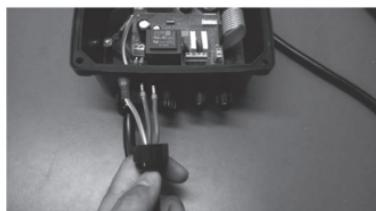
10. Introduzca el prensa cable en el extremo del cable proveniente del motor como se observa en la figura.
