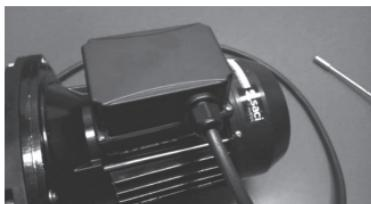
7. Atornille la tapa de bornes (tornillos del paso número 3) y fije el cable eléctrico con el prensa cables. Screw the terminal box cover (screws of the step 3) and the electrical cable with the help of the cable clamp.
