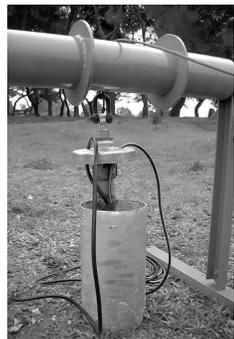
10.-Retirar la pinza y avanzar con el vehículo hasta que la pieza de suspensión se pose sobre la boca del sondeo procurando que quede centrada.
