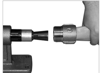
5.- Expandir el casquillo girando, la manivela hasta notar la resistencia que opone el casquillo cuando hace tope con el terminal. Repetir el expansionado, girando el terminal 45°.
