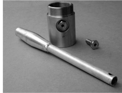
H) Rodillo de montaje desmontable - Para instalación de la tubería de 32mm hasta 6"
