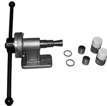
1.- Situar la junta de estanqueidad en la ranura circular existente en el interior del terminal.
