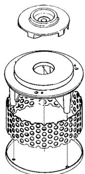
Pompa di tipo sommersibile con girante a rasamento, su disco di rasamento in gomma antiabrasione.
