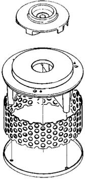
Aşınmaya karşı korumalı lastik kaplı shimmer diski, türbin ile donatılmış dalgıç pompa.
