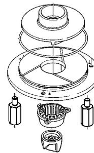
Pompa de tip submersibil cu tocator.
