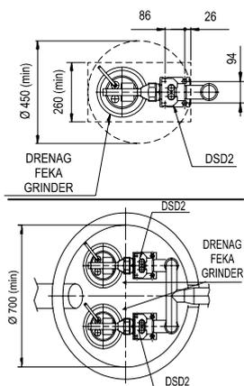
Impianto fisso con 1 elettropompa tipo Drenag 1800 T o Feka 1800 T o Grinder 1800 T, completa di quadro ED 2,5 T, con un galleggiante controllo livello MIN/MAX e 1 galleggiante di allarme
