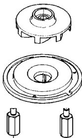
Bomba de tipo sumergible con el rodete atrasado de torbellino
