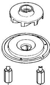
Погруженный насос с утопленной вихревой крыльчаткой.
