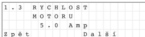
Pomocí tlačítka (▲) a (▼) zvyšujete a snižujete jmenovitou spotřebu motoru čerpadla. Pomocí tlačítka F2 přejdete do nabídky 14.
