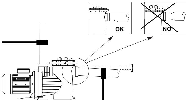
É muito importante que as tubagens de aspiração e impulsão possuam suportes independentes e que fiquem bem fixas, para que, desta maneira, a bomba não suporte o seu peso nem as vibrações produzidas pela passagem do caudal de água através das mesmas. No caso de instalar uma tubagem de impulsão de grande comprimento, aconselhamos a instalação de uma válvula de retenção para evitar que o golpe de ariete produzido pelo retorno da água ao parar a bomba provoque algum estrago.
