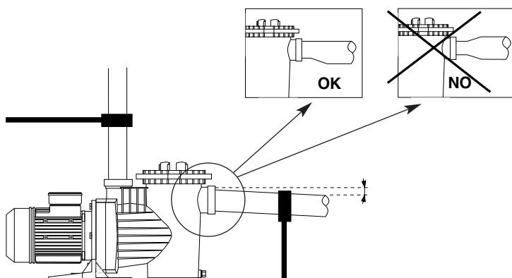
Emiş ve basma hatlarının pompa bağlantısının dışında desteklenmesi çok önemlidir. Tesisatin su akışından kaynaklanan titreşimlerin pompa bağlantısı ile desteklenmesi mümkün değildir. Uzun mesafeli basma hatlarında pompanın ani durdurulmasından kaynaklanan su çekicini önlemek için basma hattına çekvalf bağlanması önerilir.
