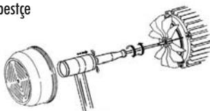
Motor şaftının (arkadan bakılarak) pompa üzerinde belirtilen yönde (SAAT YÖNÜNDE) döndüğünden emin olunuz. Eğer üç fazlı motorlarda şafın ters yönde döndüğü tespit edilirse, güç sağlayan iki faz kontrol panosundan ters değiştirilmelidir.
