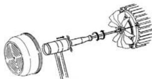
Vérifier que le sens du mouvement tournant du moteur coïncide avec celui qui est indiqué sur la plaque des caractéristiques (le ventilateur doit tourner , en regardant par le côté arrière du moteur, dans LE SENS DES AIGUILLES D'UNE MONTRE). Si la pompe est triphasique et que nous observons que le sens du mouvement est incorrect, il faudra inverser deux phases d'alimentation du tableau de protection.
