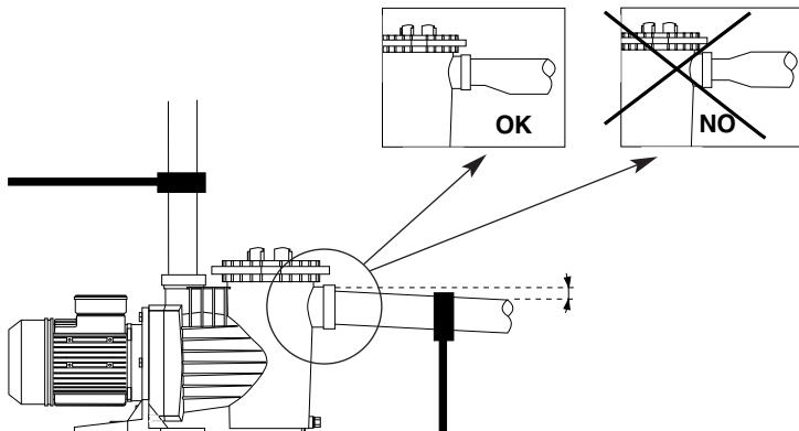
Es ist sehr wichtig, daß die Ansaugleitung über eigene Halterungen verfügt und gut befestigt ist, damit die Pumpe nicht das Gewicht der Rohrleitung tragen muß und nicht den durch die Wasserströmung bedingten Schwingungen ausgesetzt wird. Bei Ausführung mit einer langen Ansaugleitung empfehlen wir den Einbau einer Rückschlagklappe, um den bei Abschalten der Pumpe durch das rückströmende Wasser auftretenden Schlag zu verhindern, der zu Schäden an der Anlage führen kann.
