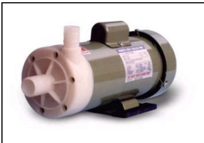
Todas las partes en contacto con el líquido están construidas en polipropileno ó en PVDF, excepto los casquillos que son de rulón/grafito, y las tóricas de FPM. Eje y arandelas de cerámica.
