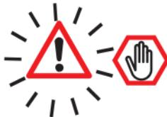
IT - 1 Lampeggio: aria nell'impianto / marcia a secco
